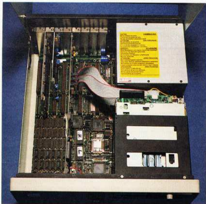
Das Innenleben des Micromint und des Sky ist nahezu identisch. Sie bieten beide viel Platz für Erweiterungen.
